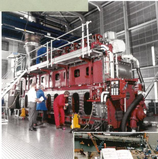
Dieselmotor M 43 während der Prüfstandsabnahme
